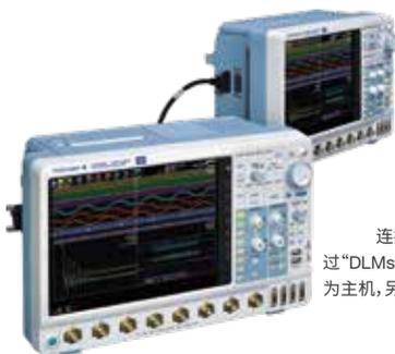
连接两台DLM5000HD/DLM5000仪器时,按下“DLMsync”菜单中的“Connect”按钮的仪器将成为主机,另一台将成为子机。两台仪器使用主机的采样时钟和触发,同步捕捉波形。
