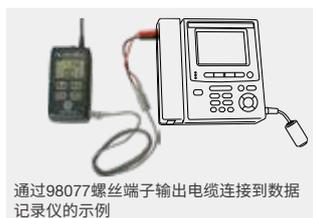
通过98077螺丝端子输出电缆连接到数据记录仪的示例
