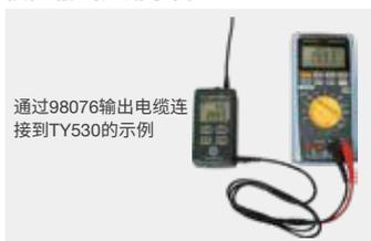
通过98076输出电缆连接到TY530的示例
