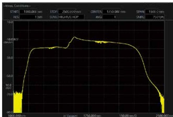
2 $\mu\text{m}$ 超连续谱光源的测量示例
