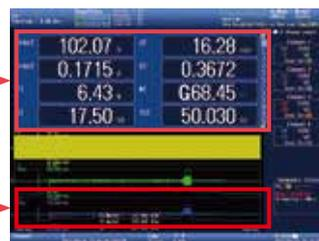
瞬态功率波形表示功率的变化趋势。可以利用光标显示任何时间点的值。
